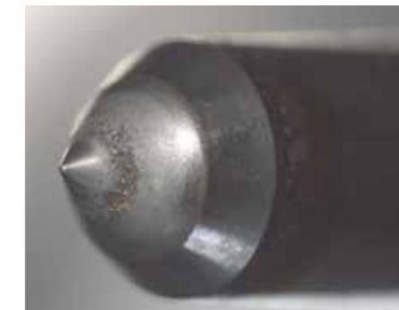
Kavitaation (vesi) vaurioittaman polttoaineruiskun neula.
