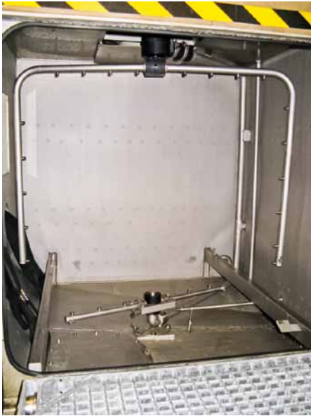
KUVA 2. Tyypillinen hydraulikomponenttien pesussa käytetty suihkupesukone.
