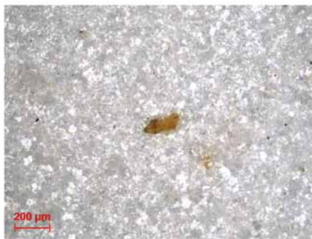
KUVA 4. Pesunesteen hiukkasjakauma, pesukone 2, tuote B (5 µm:n membraani).
