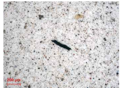
KUVA 5. Pesunesteestä otettu 5 µm:n membraani, pesukone 3, tuote C.
