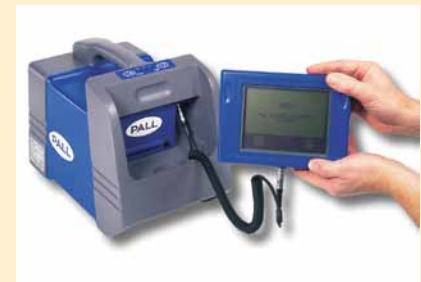
KUVA 3. Pall PCM 400 – kannettava laskuri.
