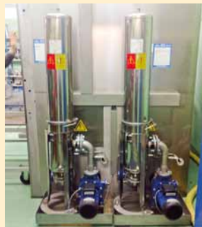
KUVA 1. Hydraulimoottorin komponenttien pesukone. Kummassakin vaiheessa on 1 µm:n suodatin.
