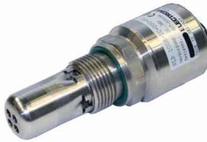
KUVA 2. Mittausanturi, mitattavat suureet: dielektrisyys, lämpötila ja suhteellinen kosteus.
