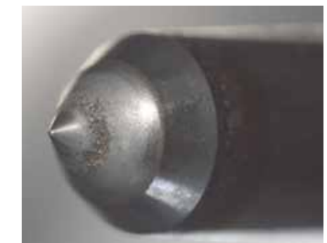
Kavitaation (vesi) vaurioittaman polttoaineruiskun neula.
